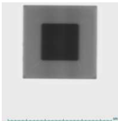
Hình 6. Ảnh chụp kiểm tra trùng khít kích thước trường sáng và trường xạ
