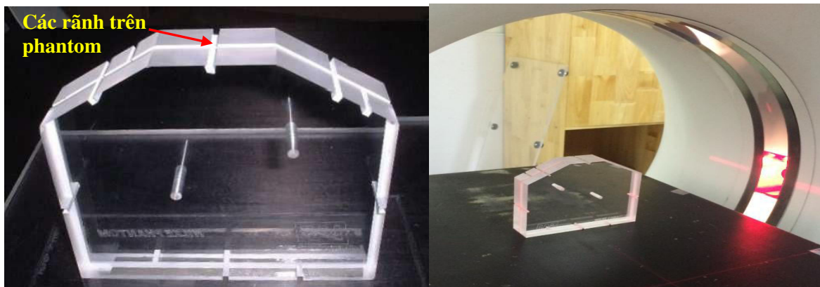
Hình 1. Đặt phantom trùng khớp với laser
